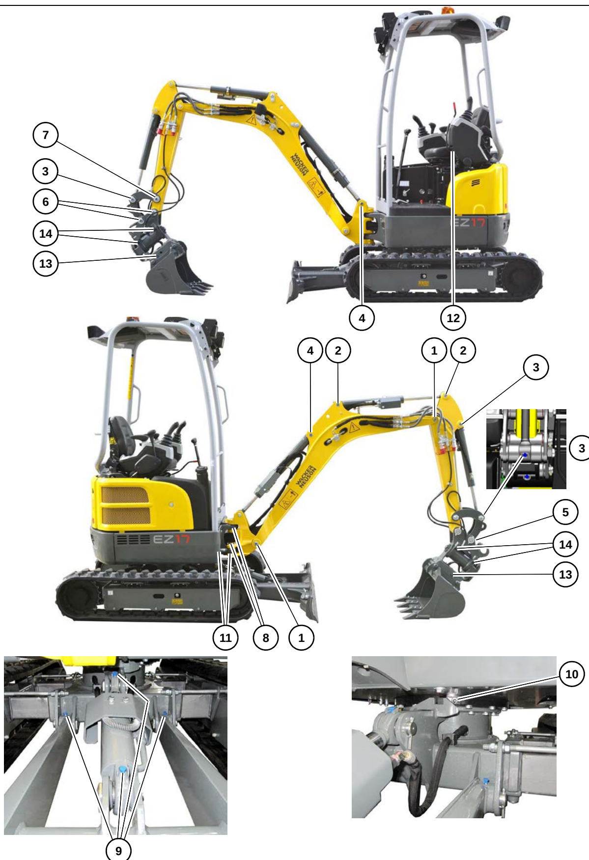
afb.191 Afbeelding met Powertilt en hydraulisch snelwisselsysteem Easy Lock (optie)
