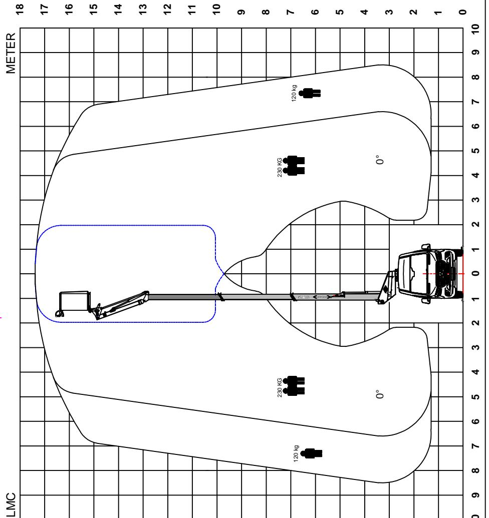
Horizontal outreach may be reduced due to vehicle stability / Die seitliche Reichweite kann sich abhängig von der Standsicherheit des Fahrzeugs reduzieren / Sensibilisation horizontale peut être réduite en raison de la stabilité du véhicule
